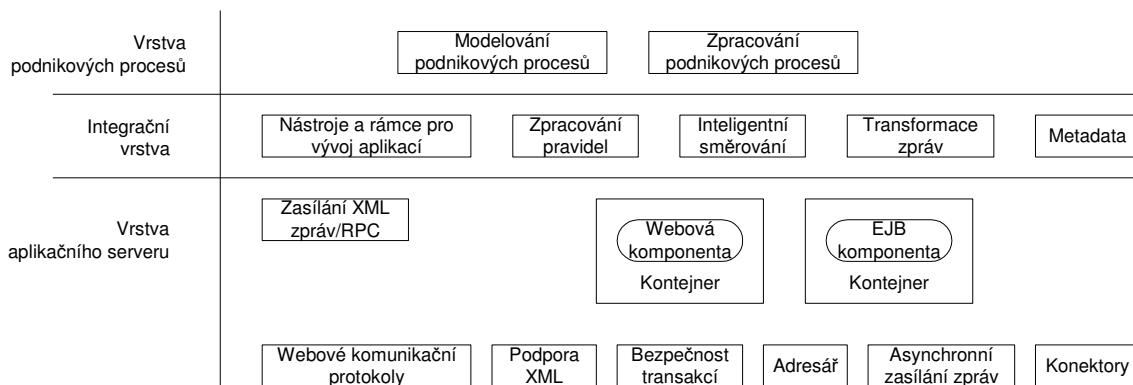
obrázek 31 - Model integračního serveru (zdroj: [SHARMA, 2001])
