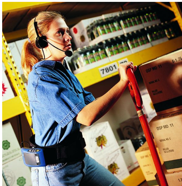
obrázek 2–19 Použití terminálu a sluchátek pro hlasovou technologii ve skladu
