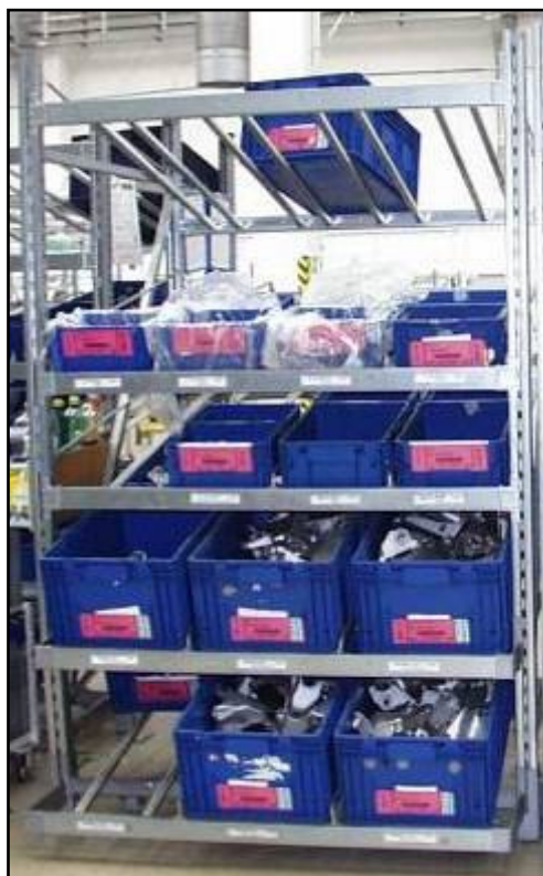
Obrázek 30 - Příklad KLT obalů, KLT regálu
